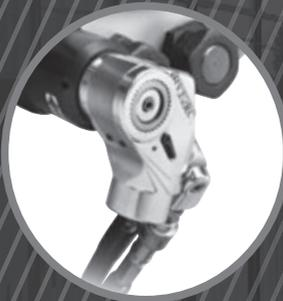
Hydraulischer Drehmoment-schrauber HYTORC Avanti
